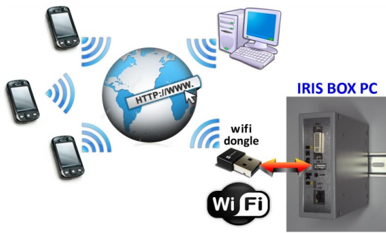
Conectividad WIFI mediante un "dongle" USB.
