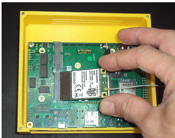
Inserción del módulo 4G+GPS en la bahía miniPCI
