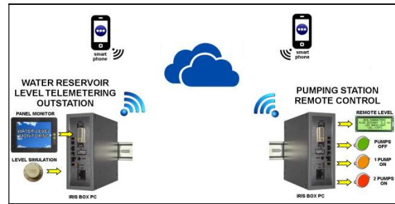
Ejemplo de telemando punto a punto de una estación de bombeo a través de la nube.
