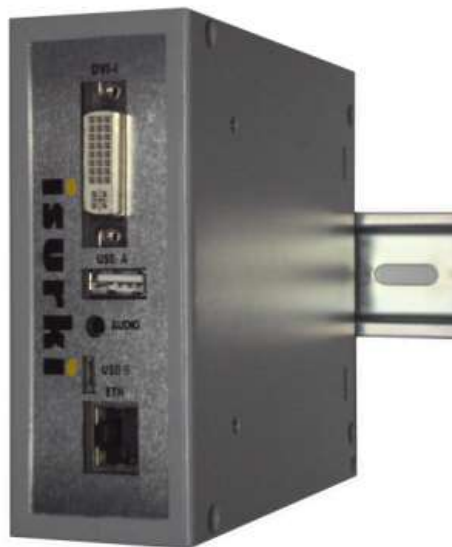
Unidad IRIS BOX TRS en ejecución para montaje en carril DIN (por defecto)
